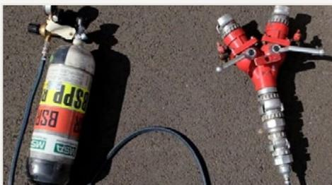
**La LINO** est un dispositif permettant de gonfler en air les établissements d'attaque et ainsi de travailler les techniques de reconnaissance et d'engagement sans l'utilisation systématique de l'eau. Elle ne se substitue pas aux établissements en eau mais elle offre un complément très simple d'usage pour travailler ces techniques ou encore manœuvrer et s'exercer dans des locaux non propices à l'utilisation de l'eau.
